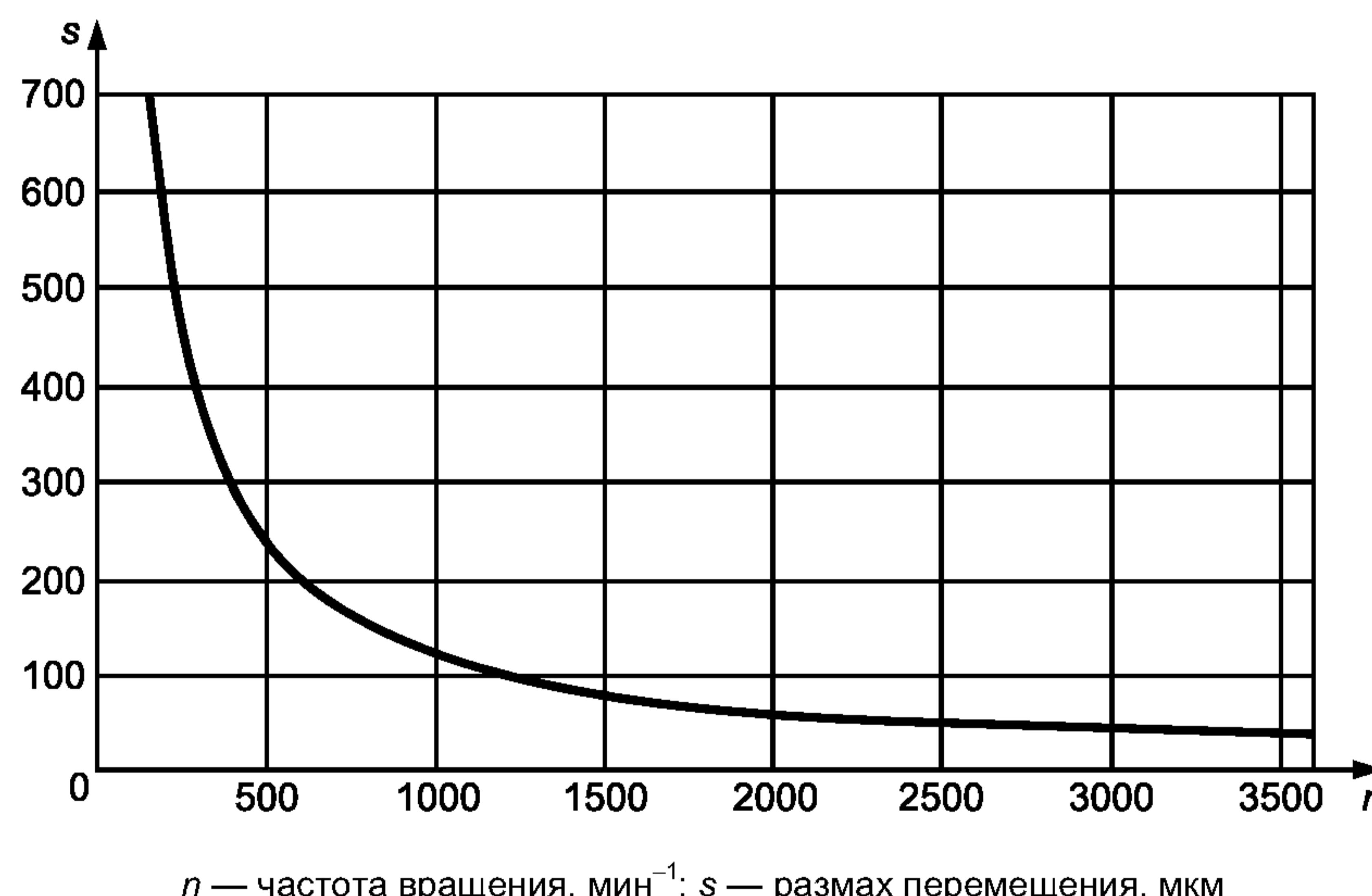
Рисунок С.1 — Изменение составляющей перемещения на оборотной частоте ротора с уменьшением частоты вращения при сохранении постоянного среднеквадратичного значения скорости вибрации 4,5 мм/с
